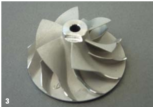
In ordine orario: 1. rotore bilanciato su VSR, sul dado si nota la fresatura della bilanciatura; 2. coreassi; 3-4. girante di compressione bilanciata: si notano le fresature di bilanciatura sul nasello della girante e sul piano interno
