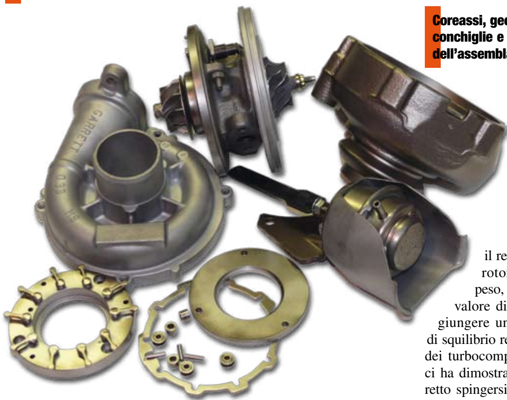
In ordine orario: 1. rotore bilanciato su VSR, sul dado si nota la fresatura della bilanciatura; 2. coreassi; 3-4. girante di compressione bilanciata: si notano le fresature di bilanciatura sul nasello della girante e sul piano interno
