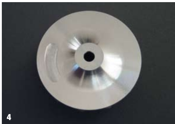
In ordine orario: 1. rotore bilanciato su VSR, sul dado si nota la fresatura della bilanciatura; 2. coreassi; 3-4. girante di compressione bilanciata: si notano le fresature di bilanciatura sul nasello della girante e sul piano interno
